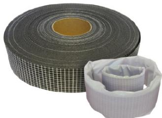
Bostik FP 340 PIPE WRAP es una cinta intumesciente flexible en base a grafito, que evita la propagación del calor, el humo y el fuego en perforaciones dejadas por tuberías en muros, suelos o techos. Puede alcanzar una resistencia de hasta 4 horas al fuego.
