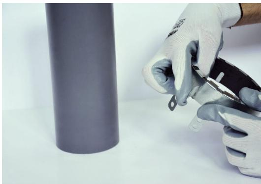
El collarín cortafuego están formado por una carcasa metálica de 0,7 mm de espesor de acero galvanizado o 0,5 mm en acero inoxidable a la que se adhieren láminas de grafito intumesciente de 2,5 mm de espesor de 30 o 60 mm de ancho, en función del diámetro del collarín.
